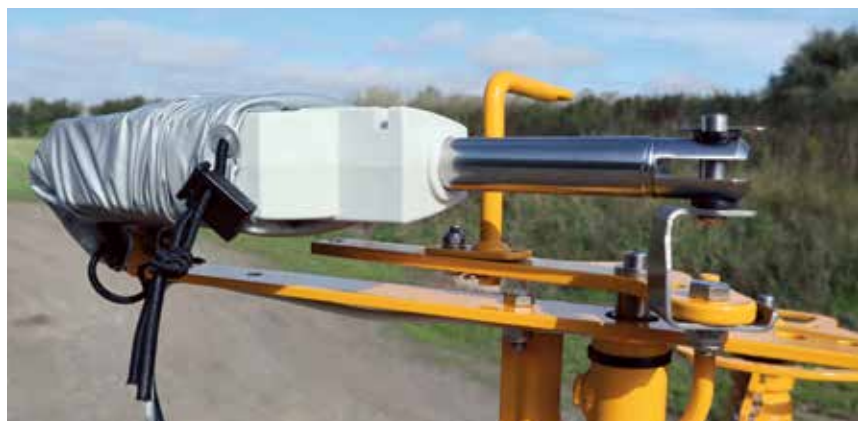
Elektrische afstandsbediening van grensstrooien voor CALBRATOR TOTZ / ICON
