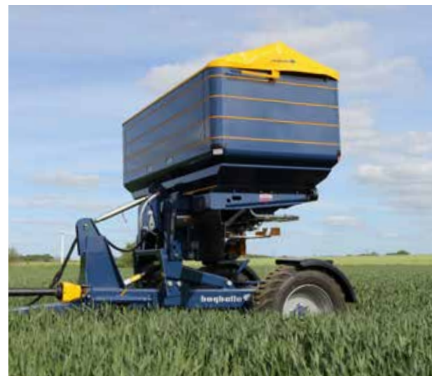
De strooier kan gedemonteerd worden van het onderstel en in de 3-punts hefinrichting gebruikt worden.
